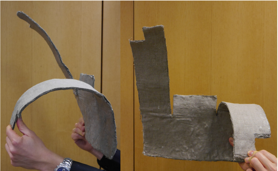
Abb. 8: Schulterpartie aus Leinenstoff mit Stärkeleim verklebt. Die Flexibilität ist deutlich erkennbar. – Yoke made from linen glued with starch glue. The flexibility is clearly visible.
