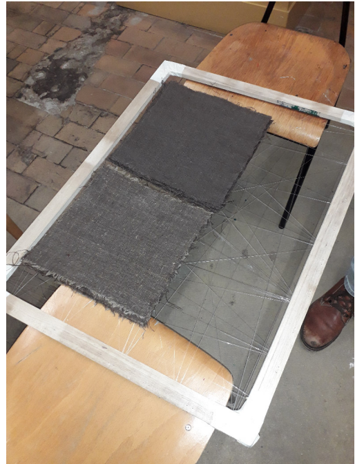
Abb. 7: Trocknen der in Leim eingetauchten Leinenstoffbahnen auf einem Rost. – Drying the linen panels which have been dipped in glue on a rack.
